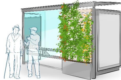
Abribus avec paroi arrière végétalisée
